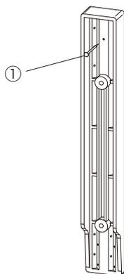
②床に対して、壁固定具が垂直になるように壁に合せ、ピン固定具を使用し、14カ所を釘ピンで固定する。力が入らない場合は、ミニハンマーを使用して固定してください。
