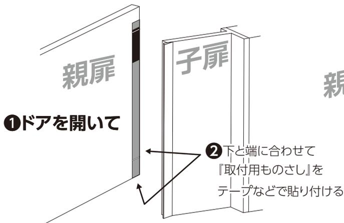
2. 『取付用ものさし』の黄色線にドア台座の下部を合わせ、両面テープで取付けます。
