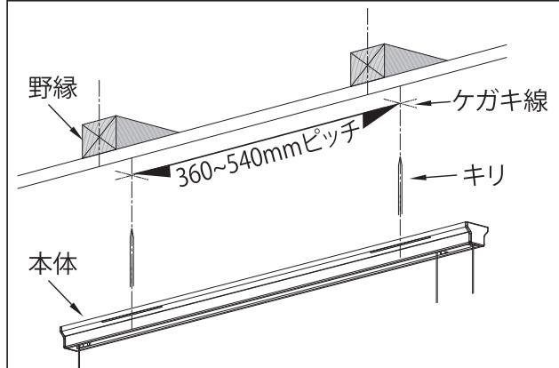
2.パッケージ台紙裏面のモノさしを使用して取付位置に印をつける。
