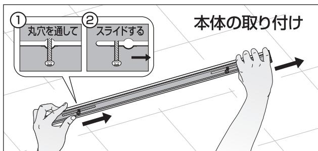
6.両方の本体取付ネジを、交互に同じ力加減で締め付けていく。
