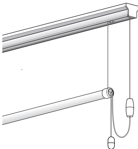
たるんだ操作ヒモをヒモ止めキャップに挟み込んで高所の位置に収納する。
