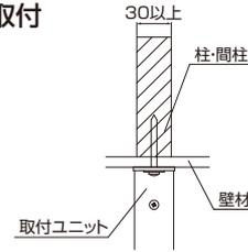
●幅30mm以上の柱・間柱へ取付けてください。
