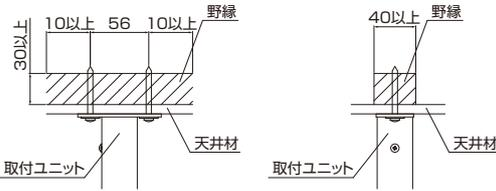
●幅40mm、厚み30mm以上の野縁に取付けてください。
